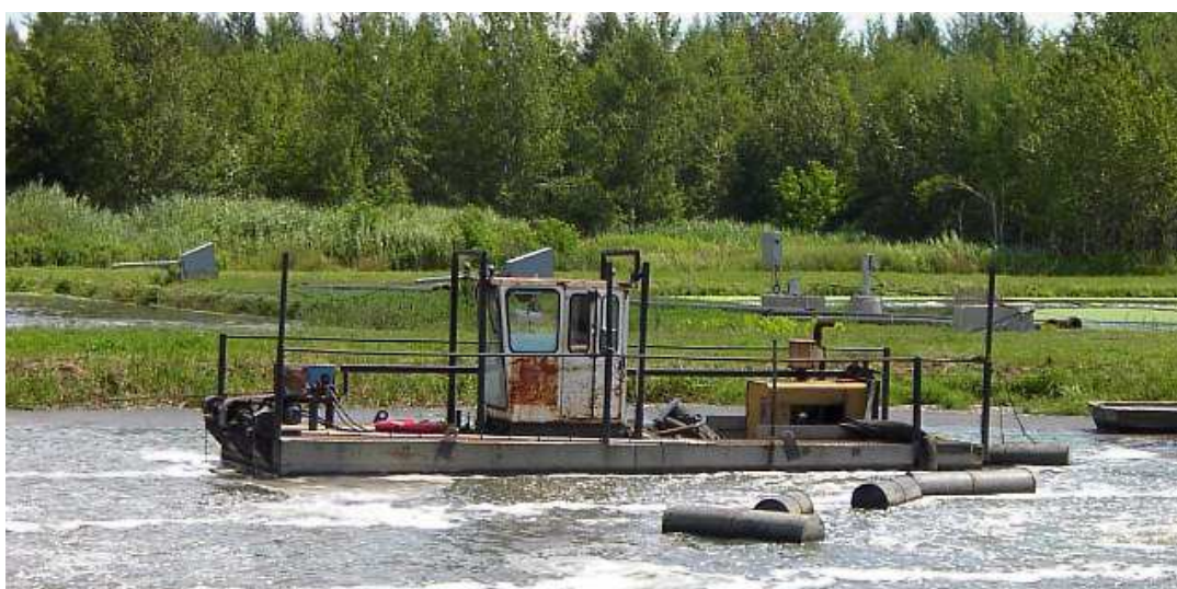
Figure 17. Drague flottante en fonction lors de la vidange
