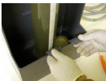
Figure 11 : Mise en place de la nouvelle coupelle
