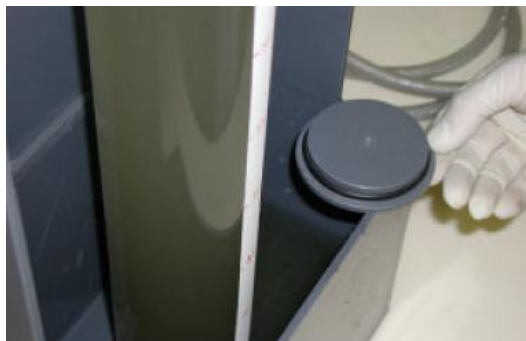
Figure 13 : Bouchage de la colonne
