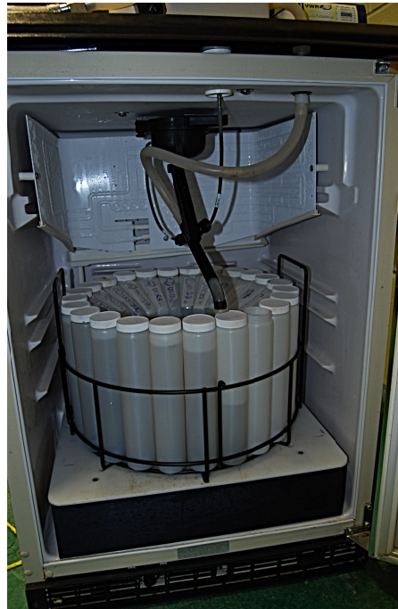
FIGURE 4.5 – Bras distributeur et bouteilles de stockage de l'échantillonneur SIGMA 900max .
