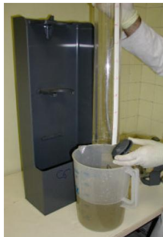
Figure 15 : Déversement de la colonne
