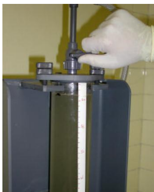
Figure 10 : Fermeture de la vanne \frac{1}{4} de tour
