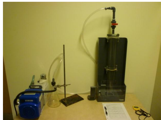
Figure 7 : Matériel ViCAs avec système de remplissage
