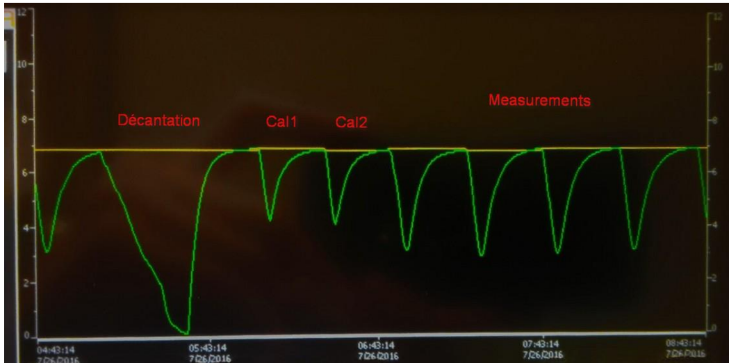
Figure 8: Courbes de calibrations (2) et de mesures (4) du RODTOX
