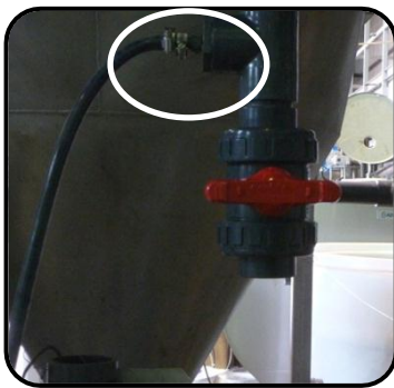
Figure 18 : Liaison pilote (Sonde de sortie)
