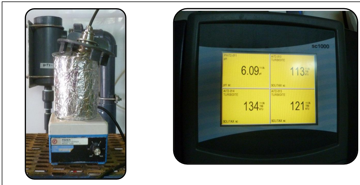
Figure 19 : Analyse de la turbidité des boues (à droite) et panneau de contrôle (à gauche)
