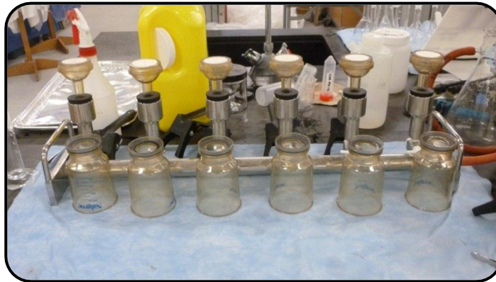
Figure 11 : Banc de filtration pour MeS avec 6 supports
