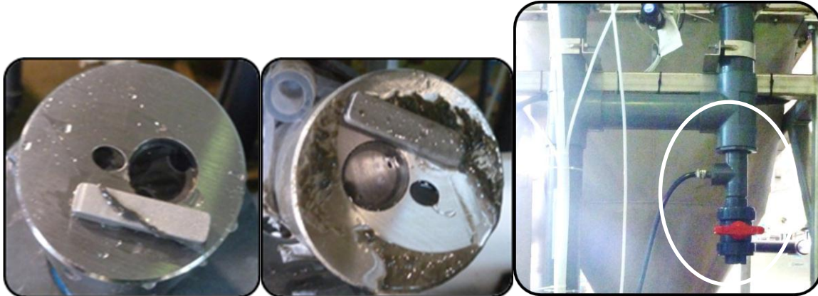
Figure 25 : Sonde d'entrée (à gauche), sonde de sortie (au milieu) après 24h de fonctionnement et emplacement du tuyau de la sonde de sortie sur un volume mort (à droite)
