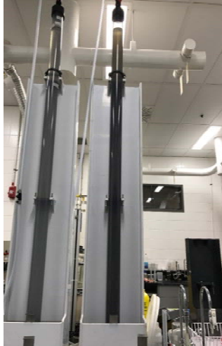
Settling column of 2m: ViCAs: V itesse de C hute en A ssainissement
