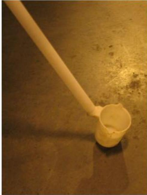
**Figure 14: Louche d'échantillonnage de capacité 500 ml**
