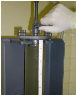
Figure 76 : Fermeture de la vanne  $\frac{1}{4}$  de tour
