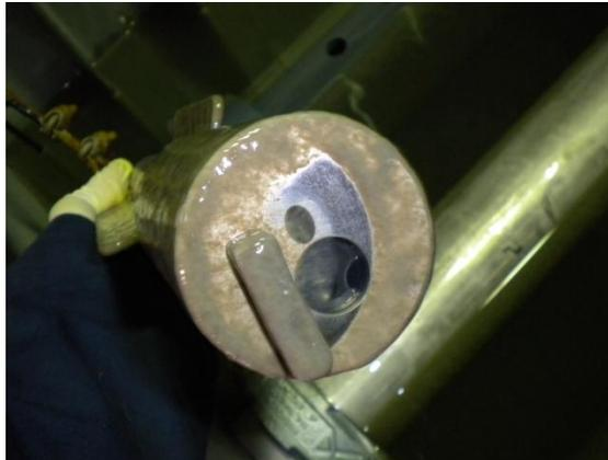
**Figure 65 : Pilote, sonde de turbidité**
