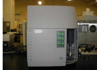
L'alignement de l'optique se fait automatiquement et ne doit être effectuée que lors du changement de dispersant ou lorsque la cellule est perturbée pour le nettoyage. Avec quelques échantillons on peut avoir à aligner une fois par jour. L'alignement est, en tout cas, facile et rapide.
