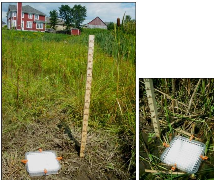
**Figure 16 : Installation de trappe à sédiments et de la mesure du niveau d'eau**
