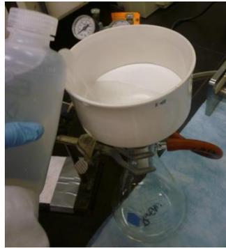
**Figure 9 : Mise en place du filtre Ø 125 mm**
