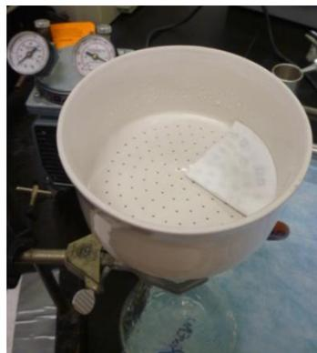
Figure 11 : Pliage du filtre Ø 125 mm
