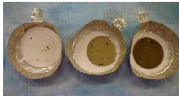
**Figure 8 : Problèmes globaux (percé, mal positionné et bouché)**
