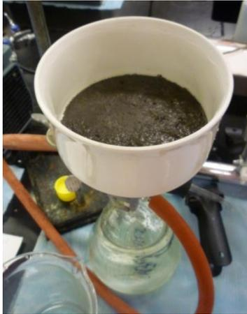
**Figure 5 : Bouchage lors d'une filtration avec des filtres Ø125 mm**
