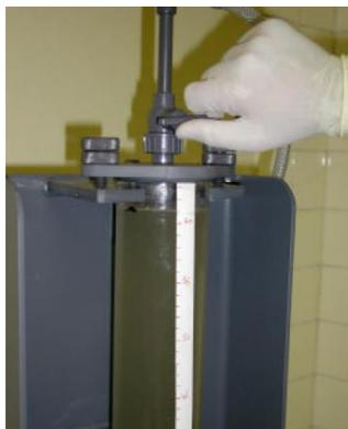
**Figure 10 : Fermeture de la vanne 1/4 de tour**
