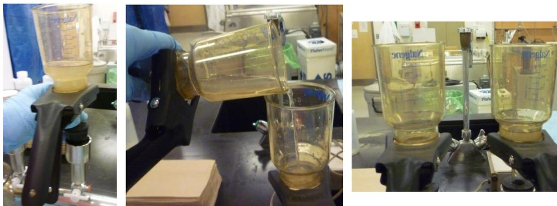
Figure 4 : Méthode pour la solution du bouchage avec des filtres Ø47 mm
