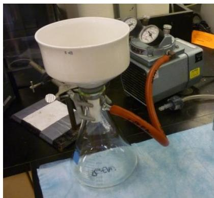
Figure 1 : Appareillage de filtration "gros filtres" (Ø125mm)
