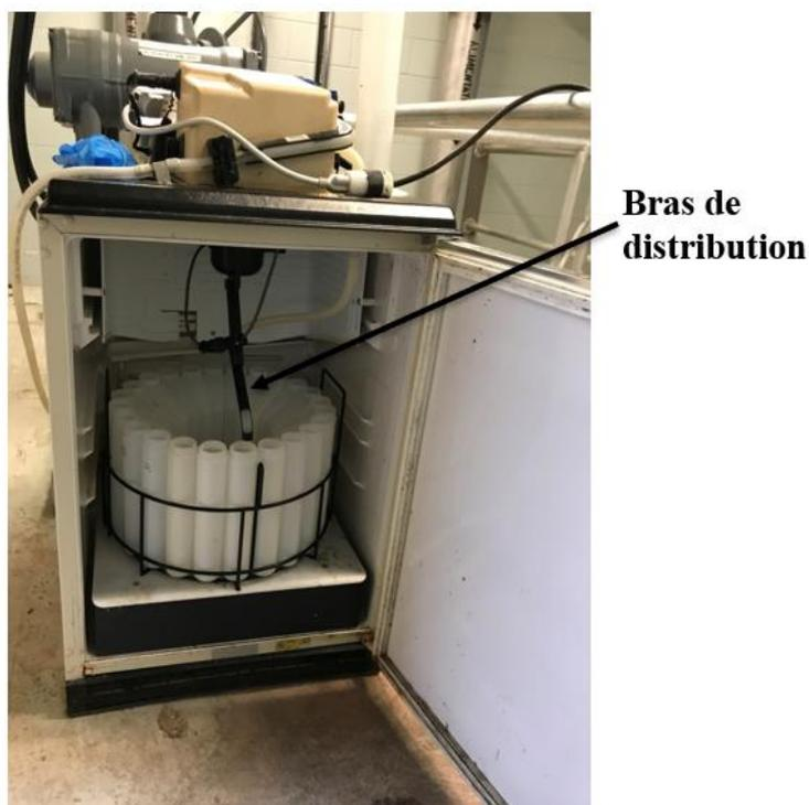
*Figure 3.5: Auto-échantillonneur Sigma 900max*
