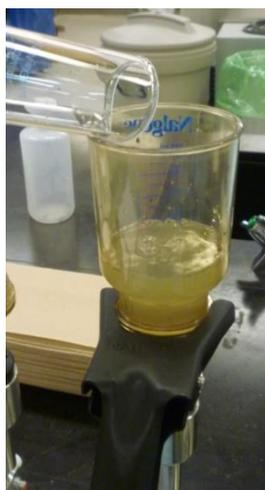
Figure 3 : Bouchage lors d'une filtration avec des filtres Ø47 mm
