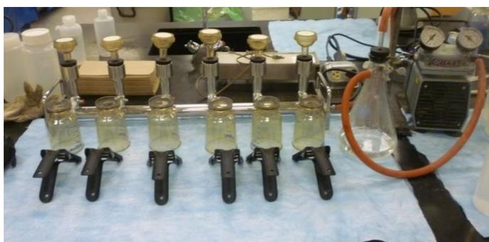
Figure 2 : Appareillage de filtration "petits filtres" (Ø47mm)
