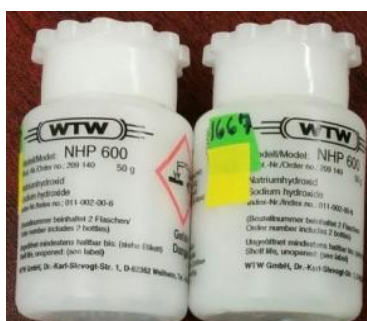
Figure 8 : Pastilles NaOH NHP600 utilisés pour la mesure de l'activité méthanogène.
