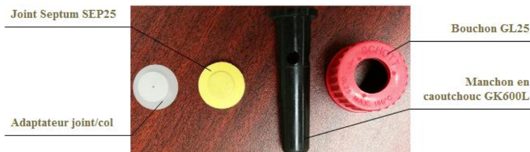
Figure 7 : Composantes du col de la bouteille Oxitop.
