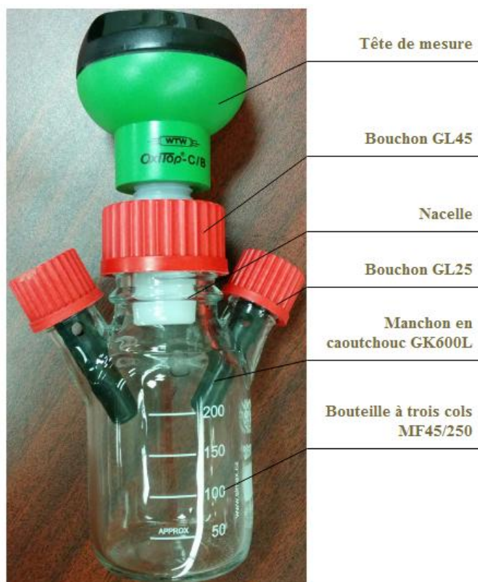
Figure 6 : Montage Oxitop pour la mesure de l'activité méthanogène.
