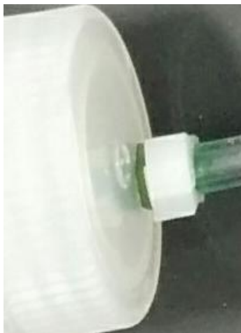
Figure 32 : Agrafe utilisée en cas de fuite entre la tubulure et l'embout.
