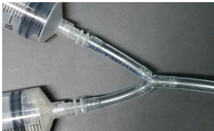
Figure 39 : Seringues reliées grâce à un connecteur en Y.
