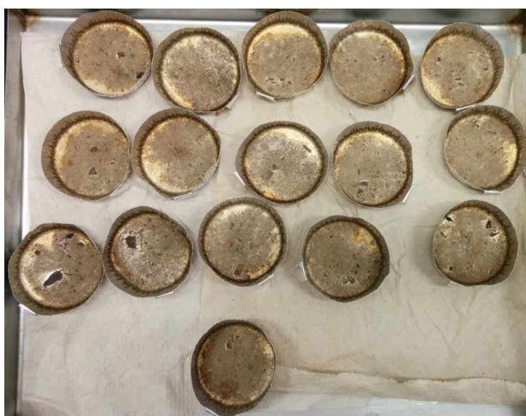
Figure 52 : Coupelles après séchage à 105°C.
