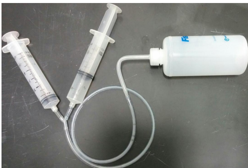
Figure 38 : Quatrième prototype pour le montage Seringue.
