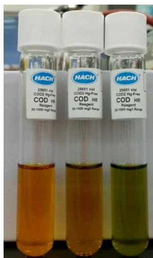
Figure 54 : Tubes tests DCO après chauffage à 150°C pendant 2 heures.
