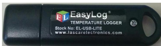
Figure 18 : Enregistreur de température utilisé lors des tests.
