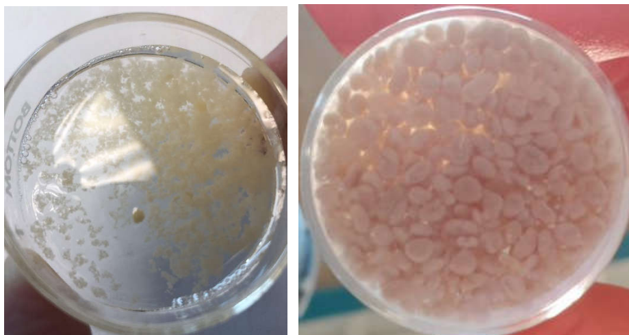
Figure 5-11 Liqueur mixte échantillonnée à la phase d'aération
