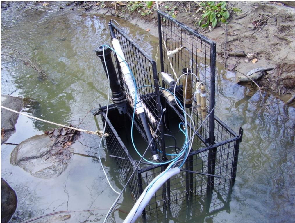
Figure 58 : Retrait des sous-sections de la deuxième cage de protection lors d'un entretien
