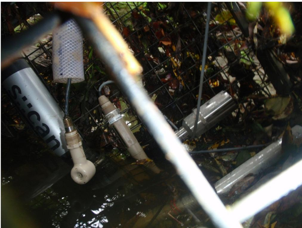
Figure 55 : Protection des capteurs contre les débris
