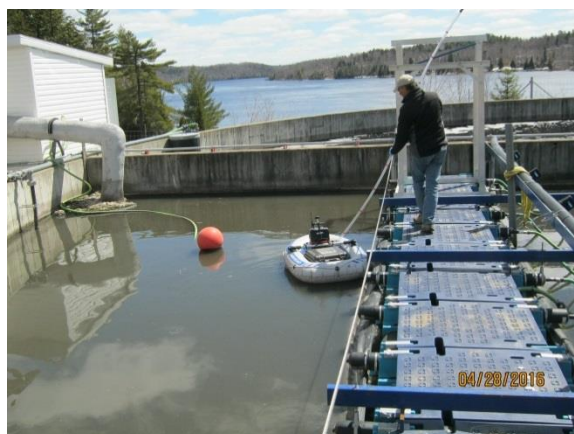
Figure 22 Sonde sur une embarcation flottante dirigée par Yves Payette d'Echotech
