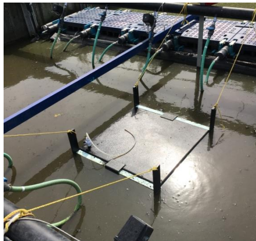
Figure 25 Boîte à gaz pour la récupération du gaz installée sur l'étang dans la deuxième zone de clarification CI2
