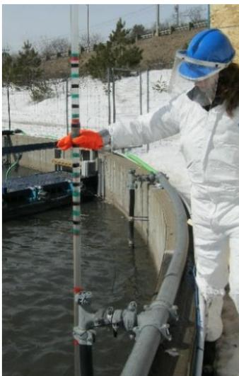
Figure 3.14 : Opérateur en action lors d'une mesure de hauteur de sédiments à l'aide d'une jauge à boues
