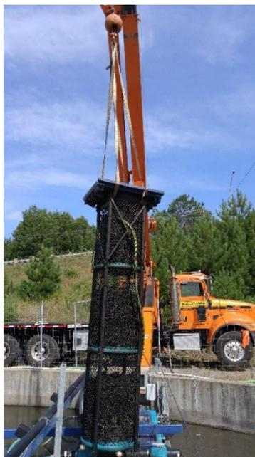
Figure 3.19 : Grue utilisée pour mesurer la masse des cages colonisées
