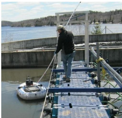
Figure 3.16 : Opérateur en action lors d'une mesure de hauteur de sédiments à l'aide d'un échosondeur numérique
