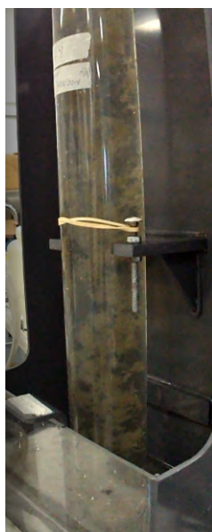
FIGURE B.1 – Particules lors d'un test ViCAs après floculation.
