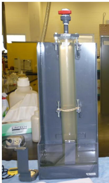
FIGURE 3.14 – Colonne de décantation utilisée pour les tests ViCAs.
