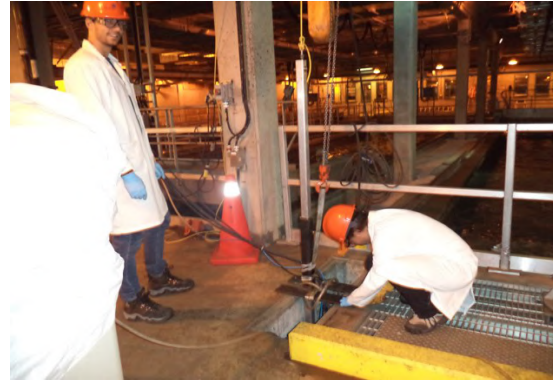
(b) Support à capteurs relié à un monte charge
