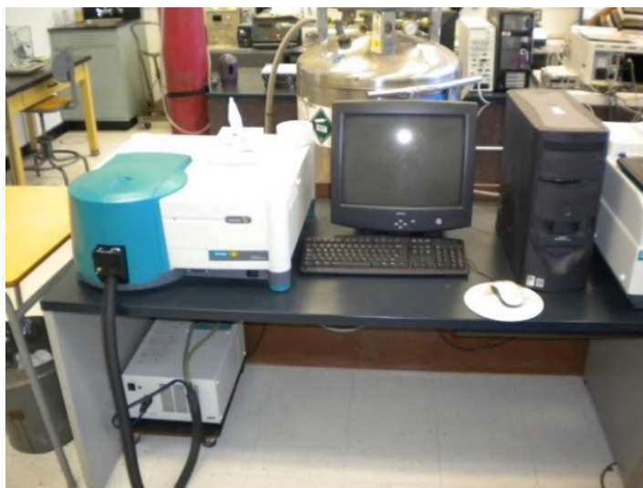
FIGURE 3.25 – Fluorimètre de type Eclipse commercialisé par l'entreprise Varian.
