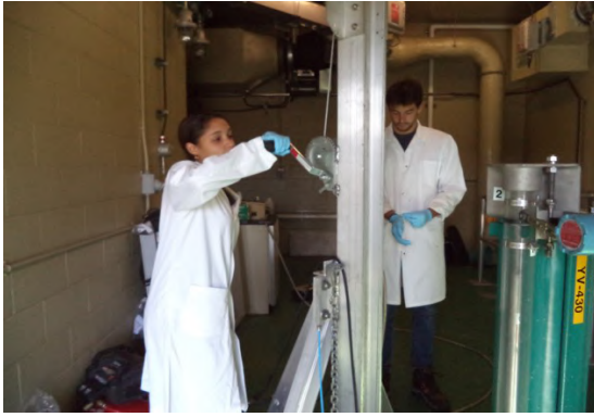
(a) Support à capteurs installé sur un treuil
