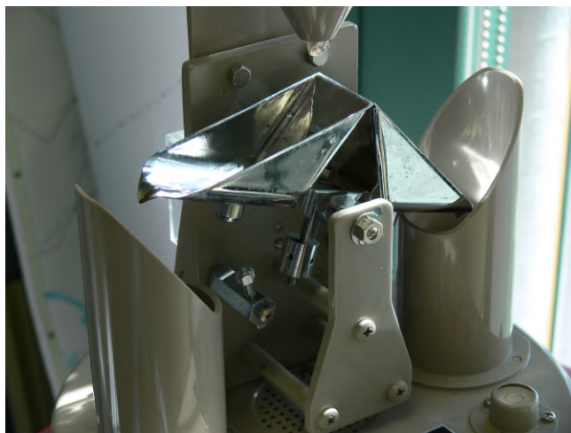
FIGURE 3.6 – Pluviomètre à auget basculant (photo courtoisie de Yves Lanthier de la Ville de Québec)
