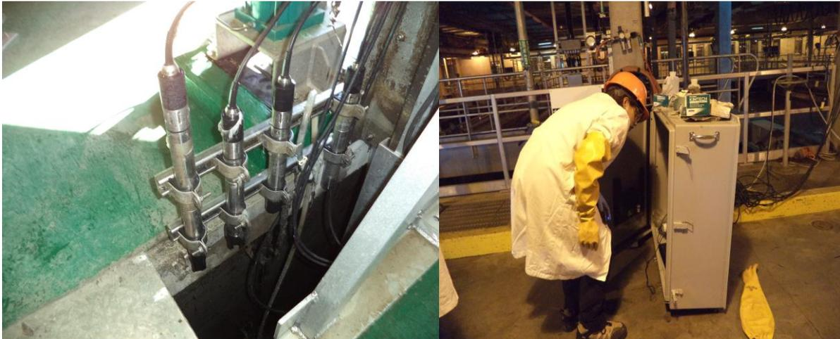
**Figure 6** : Photos des capteurs nettoyés (à gauche) et de la station monEAU (à droite).
