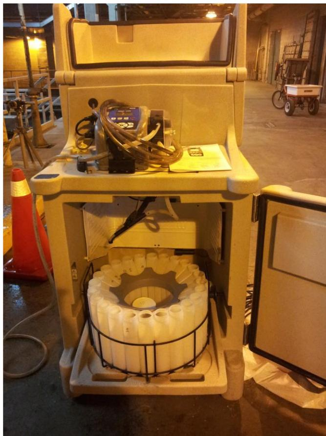
**Figure 4** : Photo de l'échantillonneur automatique avec ces 24 flacons.
