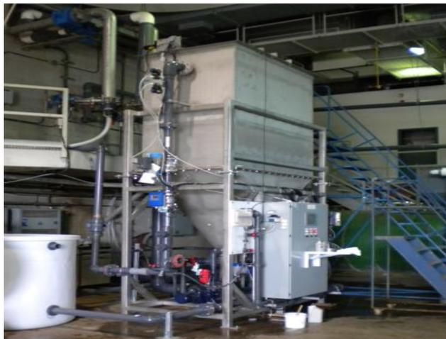
Fig. 4 : Photographie du décanteur primaire pilote
