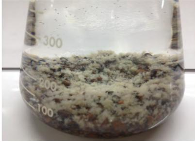
Figure 7 : échantillon de média filtrant avec biofilm excessif (photo fournie par la station)
