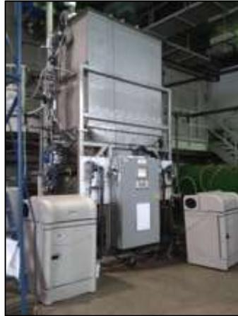
**Figure 3:** Pilote de décanteur primaire du projet primEAU
