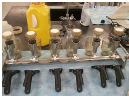
A gauche, figure 7 : banc de filtration Büchner
