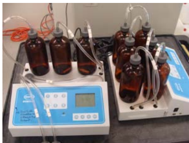
A gauche, figure 14 : Les appareils BODTrak
