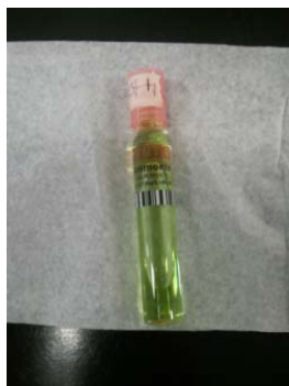
Figure 20 : Tube d'analyse ammoniac
