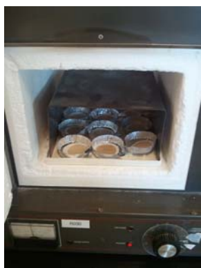
A gauche, figure 9 : Calcinateur 550°C
