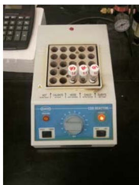
Figure 11 : chauffe tube à 150°C
