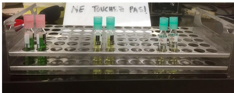
Figure 3 : Détermination de la concentration en  $NH_4^+$  avec les tubes HACH LANGE
