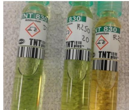
Figure 4 : Différentes colorisations de tubes Hach  $\text{NH}_4^+$  après réaction
