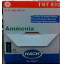
*Figure 8 : Photographie du kit permettant de mesurer le taux d'azote ammoniacal dans les échantillons*
