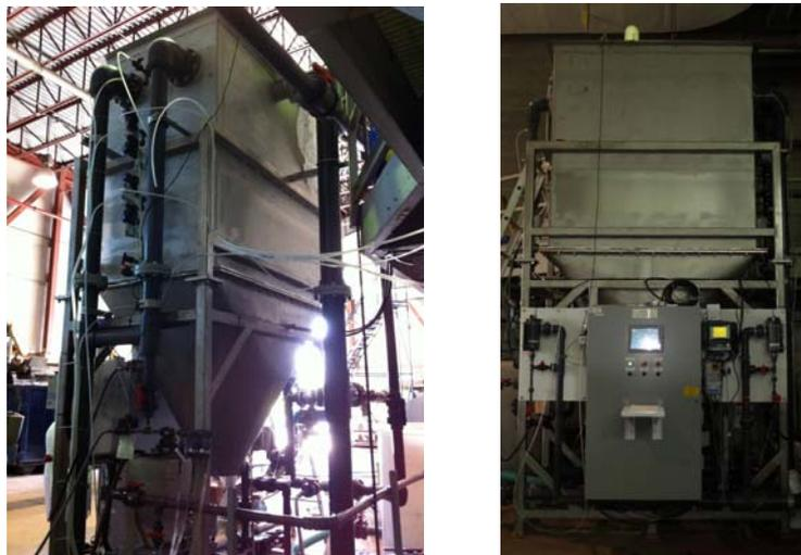
Figure 4 : Photographies du décanteur primaire pilote
