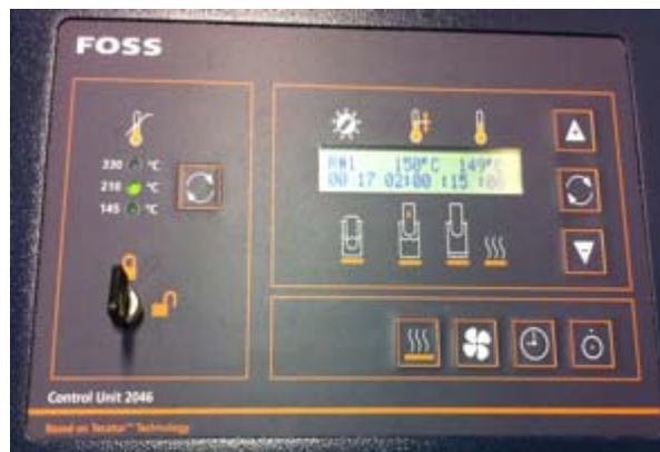
Figure 6 : Photographies représentant l'unité de contrôle et d'extraction de la méthode Soxtec
