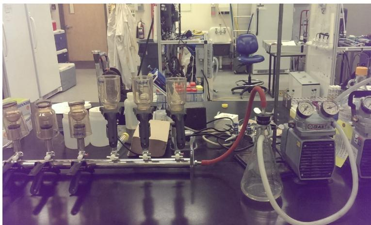
Figure 15 Appareil de filtration Buchner
