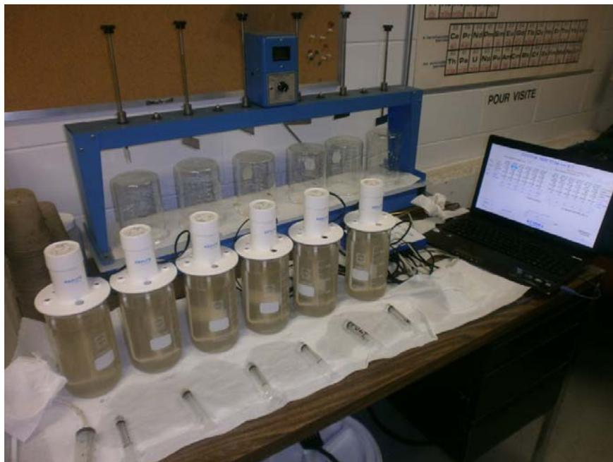
Figure 25 - Banc de jar-test
