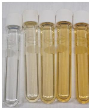
Figure 5: gamme d'étalonnage (0-100 mg/L)
