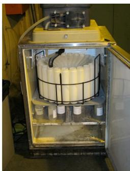
Figure 7 : Echantillonneur utilisé
