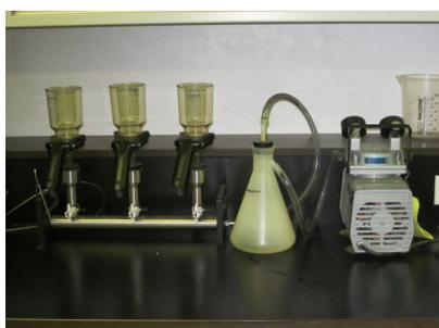
Figure 8 : Système de filtration sous vide
