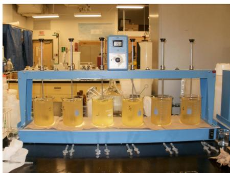
**Figure 6 : Dispositif pour les jar-tests**
