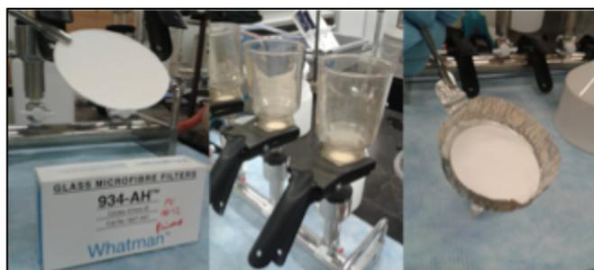
Figure 32 De gauche à droite, filtres en fibre de verre, supports filtrants et filtre dans sa coupelle
