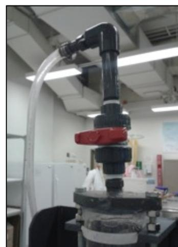
Figure 31 Raccord reliant la t te de la colonne   la pompe
