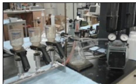
Figure 6 Banc de filtration des MES
