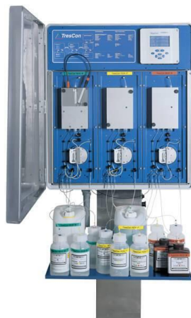
Figure 27. TresCon avec les trois modules d'analyse ("WTW GmbH – Système d'analyseur TresCon®," n.d.)
