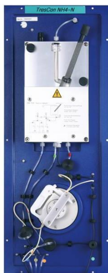
Figure 28. Module d'analyse NH 4 -N ("WTW GmbH – Analyseur TresCon® pour l'ammoniac," n.d.)
