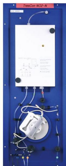
Figure 30. Module d'analyse NO 2 -N (“WTW GmbH – Analyseur TresCon® pour nitrite,” n.d.)
