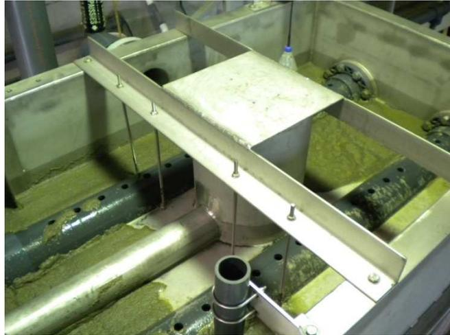
**Figure 5 : Photo prise au dessus du Pilote primEAU en cours de vidange après fonctionnement avec de l'eau usée**
