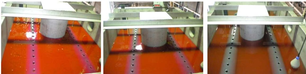
Figure 11 : Evolution de la coloration de l'eau recyclée lors d'un test traceur à la RWT, vue du haut du pilote
