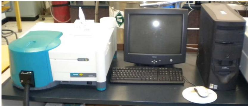
**Figure 1 : Fluorimètre Varian et son système de commande et d'acquisition**
