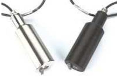
La sonde différentielle de pH avec un thermomètre intégré est aussi de marque Hach. Elle est disposée en haut du décanteur de façon à suivre les possibles évolutions du pH tout au long des manipulations. Un ajout de produit chimique comme un coagulant-floculant peut engendrer une variation de pH. Sur la figure 4 la valeur de pH est donnée dans le cadre nommé **pH surface**.
