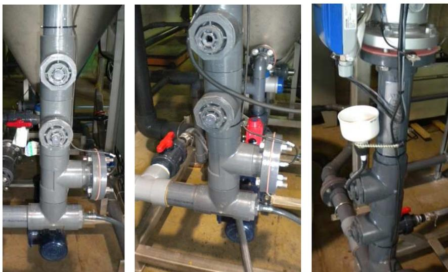
**Figure 8 : Point d'injection des solutions de traçage**
