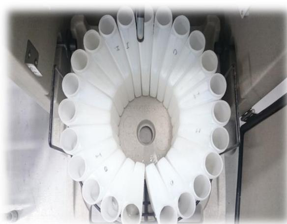
24 bidons pour une prise d'échantillons optimale sur 24 heures
