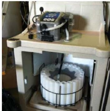
Figure 10 : Echantillonneur automatique
